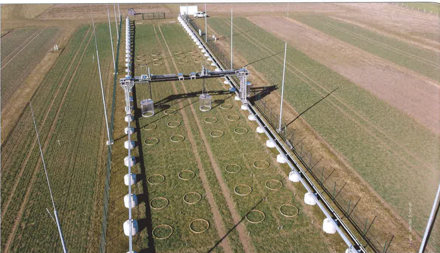
Abb. 1: Der Portalkran im ZALF-Landschaftslabor „AgroScapelab Quillow“ (Uckermark) mit automatischen Hauben zur Messung der Treibhausgasflüsse in drei Blöcken mit Böden unterschiedlichen Erosionsgrades (Fruchtfolge 2020–23: Grünroggen-Raps-Triticale).
